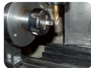
چهارگوش کردن قطعه به کمک دستگاه تقسیم
